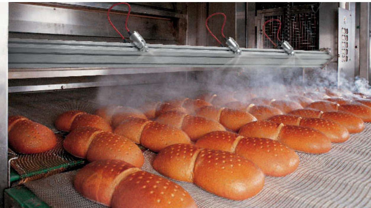
Das Düsenventilsystem Variospray HP zerstäubt selbst höher viskose Substanzen in kleinsten Mengen problemlos
